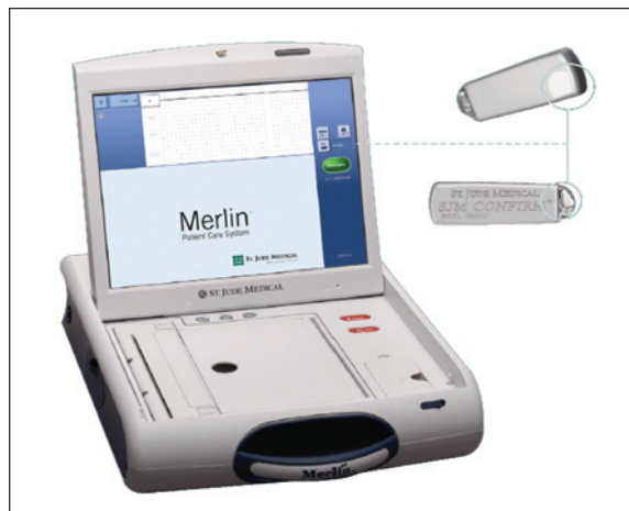
Figura 3 - Programador Merlin, associado ao MCI Confirm (6,5 cc - o menor dispositivo deste tipo).
