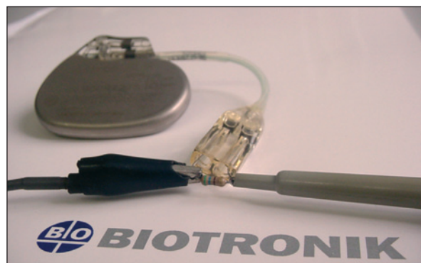
Ilustração 1 - Detalhe do conector bifurcador; ponta de prova e carga aplicada.
