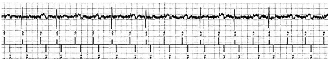
**Figura 1:** Traçado com velocidade em 25 mm/segundo. Marcapasso programado em modo dupla-câmara 90 ppm. A EGM: eletrogramas atriais; Canal de Marcas: Ap = Atrial pace; As = Atrial sense; Vp = Ventricular pace.
